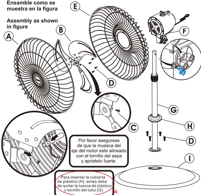
Por favor asegurese de que la muesca del eje del motor este alineado con el tornillo del asa y apriete fuerte.
