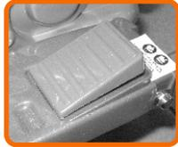
**Presione el pedal para avanzar y deje de presionar para frenar.**
